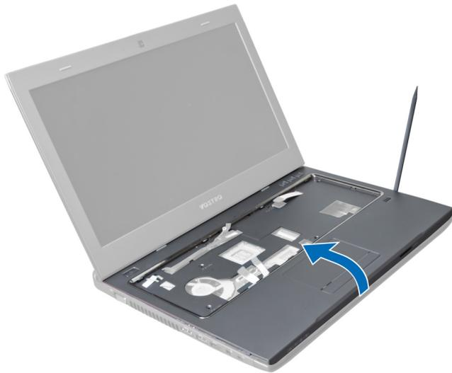
**11.** Deslice el reposamanos hacia afuera y levántelo para extraerlo del equipo.
