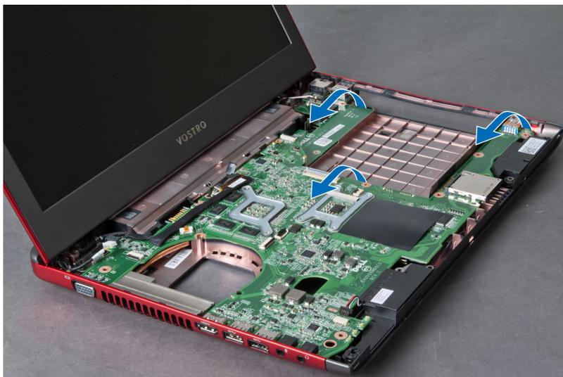
7. Deslice la placa base y levántela del chasis.
