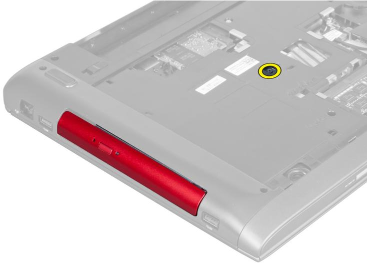
4. Utilice un destornillador de cabeza plana para desprender la unidad óptica fuera del equipo.
