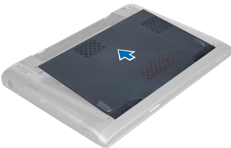
5. Levante la cubierta hacia arriba y retírela del equipo.
