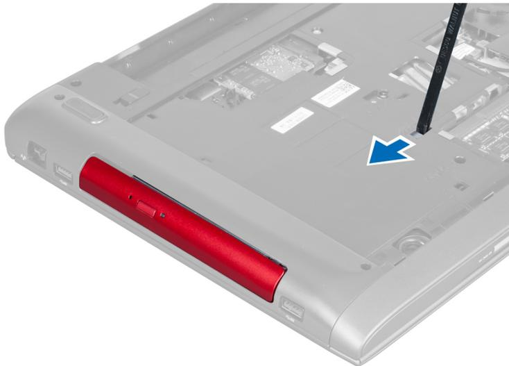
5. Deslice la unidad óptica hacia afuera y extráigalo del equipo.
