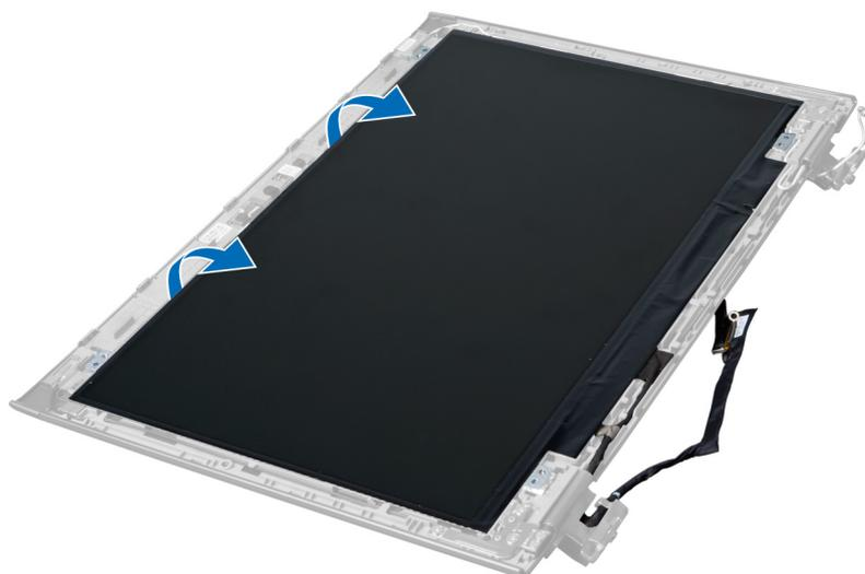
5. Despegue la etiqueta para extraer la pantalla de su ensamblaje.
